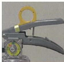
× レバー支えの脱落
