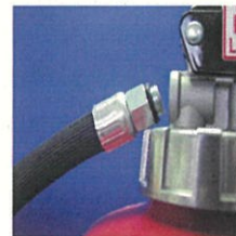
× 緊結ネジの破損 × ホースの脱落
