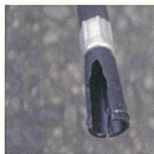
× ノズルの破損
