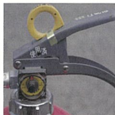
× 表示装置の脱落
